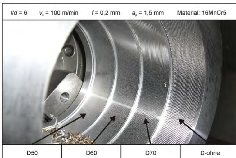
Bild: Oberflächengüte bei unterschiedlichen Dämpferpositionen
